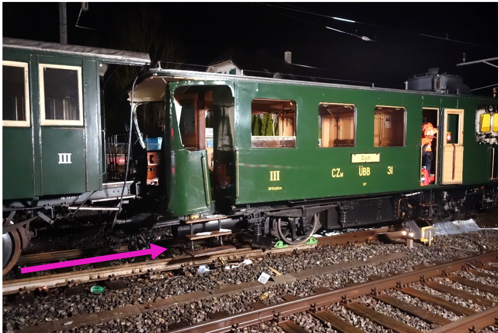
Abbildung 4: Foto der Unfallstelle. Beschädigung am Dampftriebwagen. Lila Pfeil: Fahrtrichtung des Zuges.
