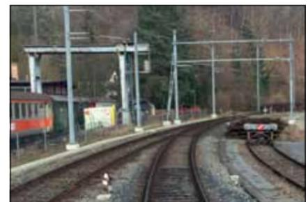
Anschließend passieren wir ein **«Fahrt mit Vorsicht» zeigendes Zwergsignal**. Nach den Lokalen Bestimmungen **korrekt**, nach RADN müsste es **Fahrt** zeigen.
