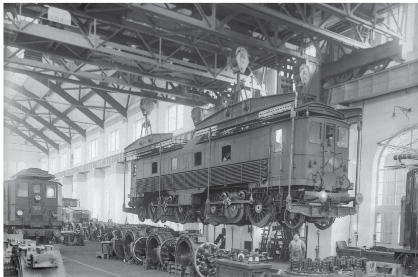
Capannone di montaggio con una Be 4/6 sul gancio di una gru. Questa locomotiva è stata messa in servizio sul San Gottardo dopo la Prima guerra mondiale (SBB Historic F_112_00001_011).
