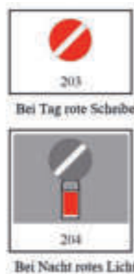
Figura 1: Segnale a disco che indica fermata. Questi segnali della prima ora vengono utilizzati ancora oggi per coprire binari chiusi, ostacoli, ecc. La linea diagonale bianca serve a distinguere meglio il segnale dall'area circostante (PCT 2020 R 300.2, par. 2.2.1).
