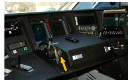
Poste de conduite d'un TGV POS. Flèche jaune : plaque métallique à toucher avec le doigt, qui peut être utilisée parallèlement à la pédale. Elle permet également de conduire le train en position debout.
