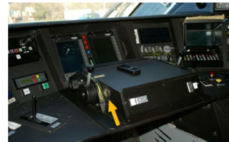
Cabina di guida del TGV POS. Freccia gialla: piastra metallica da toccare con il dito, che può essere azionata parallelamente al pedale. Consente di gestire il treno anche in posizione eretta.
