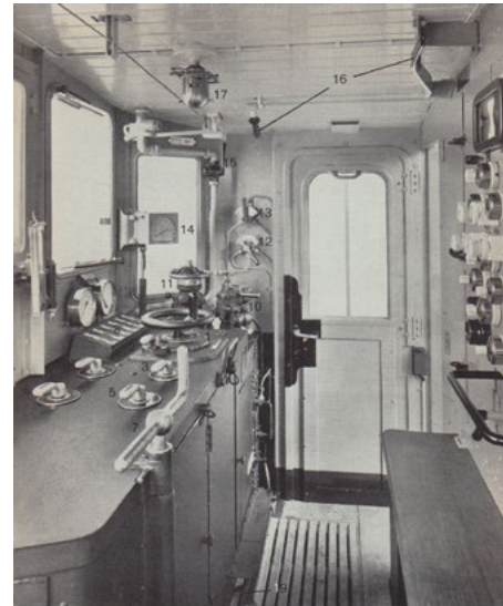
Cabina di guida di una Ae 4/7 del 1927. Pedale dell'uomo morto pos. 19.
