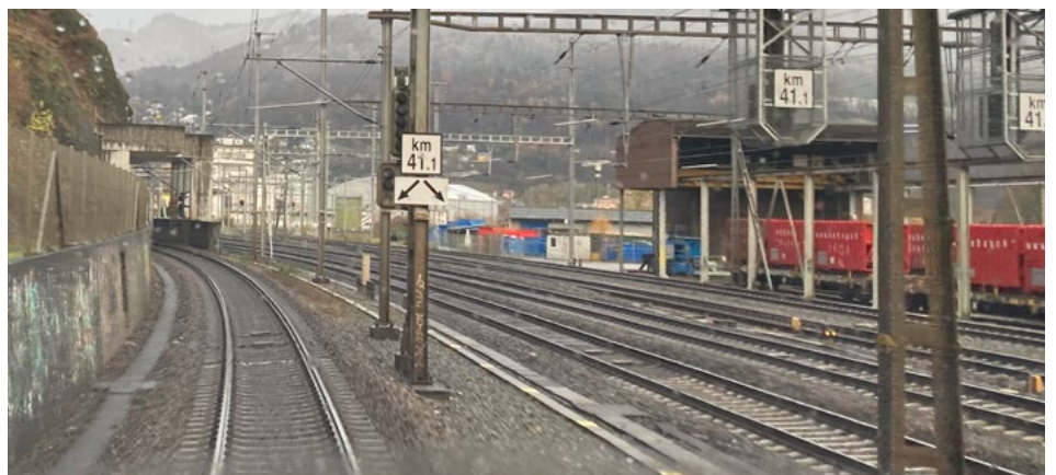
«Tavola di avviso per la modifica della velocità massima». Da qui la velocità massima consentita è di 90 km/h.
