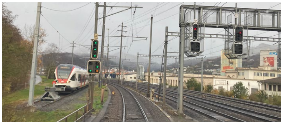
Segnale principale della sezione d'entrata. Da qui, il macchinista deve rispettare la velocità indicata dal segnale avanzato.
